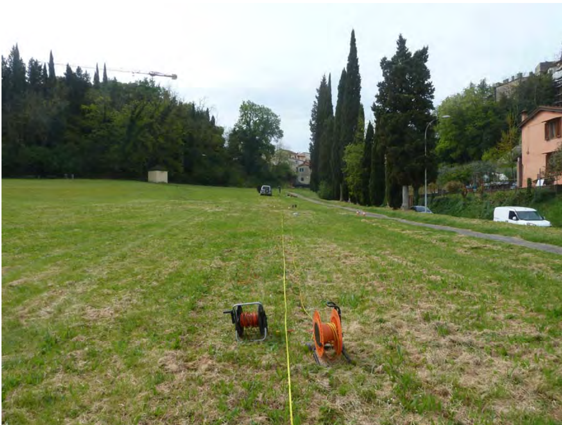
Indagine ERT2d, indagine in sismica a rifrazione in onde P / MASW in onde di Rayleigh: documentazione fotografica
