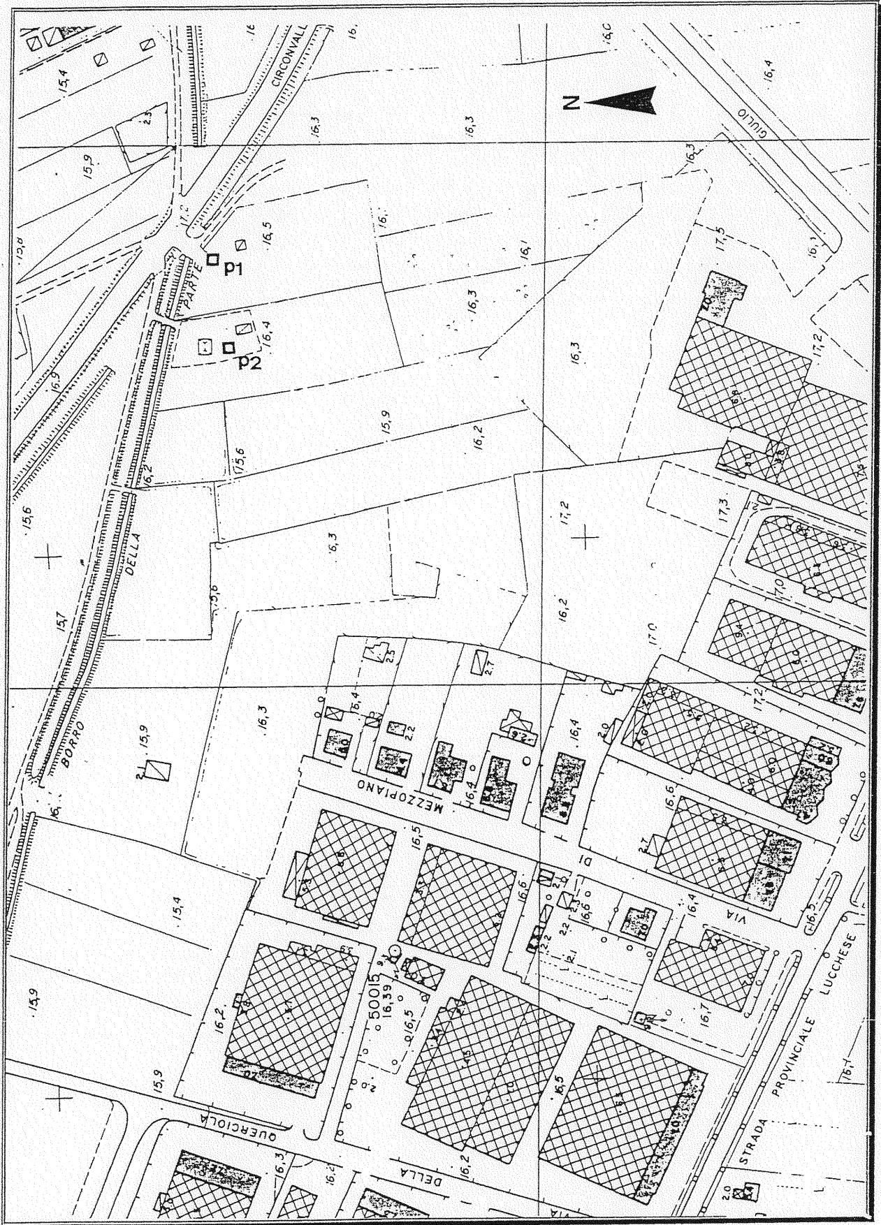
Fig. 4: ubicazione delle prove penetrometriche.
