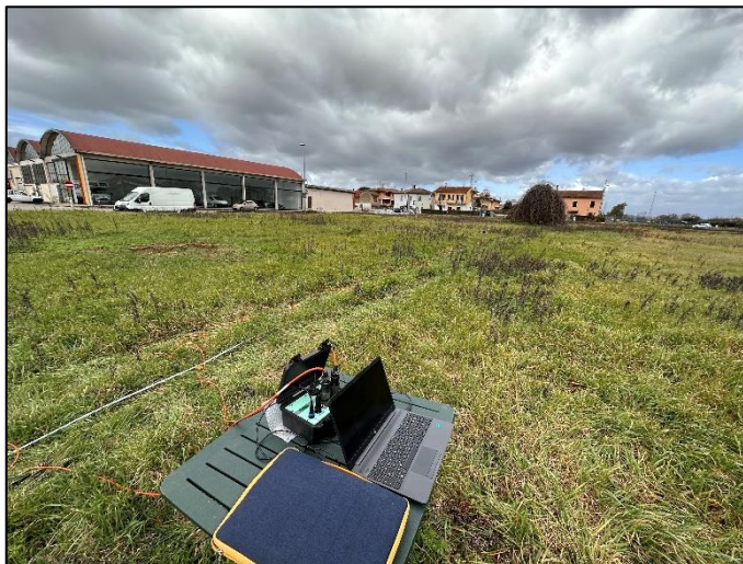
Figura 1: Vista dello stendimento MASW effettuato
