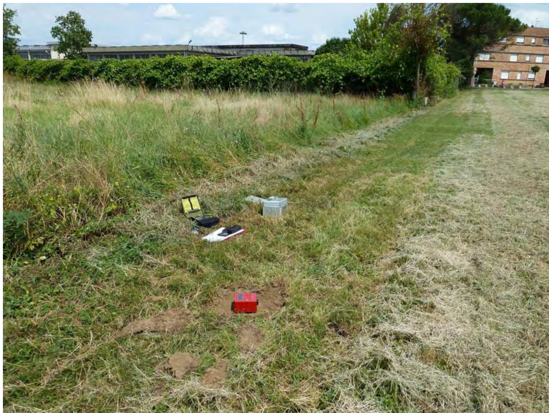
Indagine Tromografica – Sito 09 - Documentazione fotografica.
